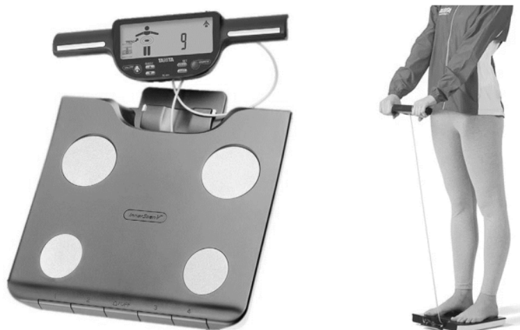
Slika 1. Segmentarni portabl uređaj za bioelektričnu impedancu (model Tanita BC-601) kojim je sproveden monitoring varijabli tjelesnog sastava (Izvor: https://tanita.eu/bc-601 )
